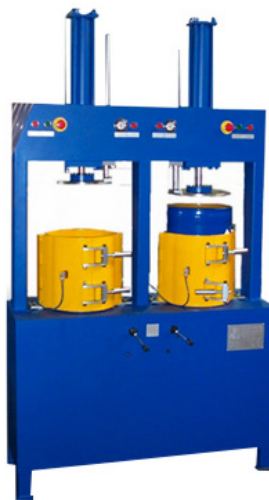
Экструдер для бочек с двумя пресс пластинами, с одним гидравлическим цилиндром для одновременного спуска обеих прессованных пластин или с двумя гидравлическими цилиндрами для независимого спуска каждой прессованной пластины.
