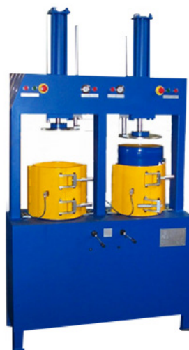
Extrudeuse pour tonnelets à double plaque de pressage , avec un seul cylindre hydraulique pour la descente simultanée des deux plaques de pressage ou avec deux cylindres hydrauliques pour la descente indépendante de chaque plaque de pressage.
